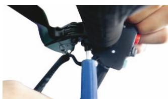
Podesite položaj ručice kočnice i pričvrstite šrafove za fiksiranje sa 5mm šestougaonim imbus ključem.
